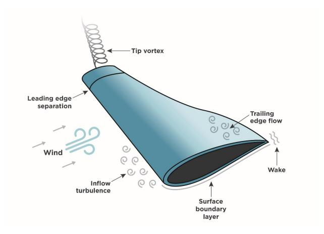
FIGURE 2: AIRFLOW AROUND A ROTOR BLADE
